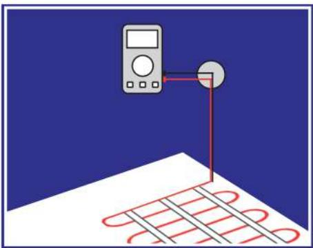
Проверьте работоспособность системы. Подайте напряжение питания на терморегулятор и включите его, согласно инструкции к терморегулятору. Подождите некоторое время и убедитесь в том, что секция нагревается. Выключите систему и отключите напряжение питания.
